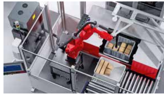
Automatische roboter- und KI-gestützte Arbeitsplatzlösung fürs Picking
