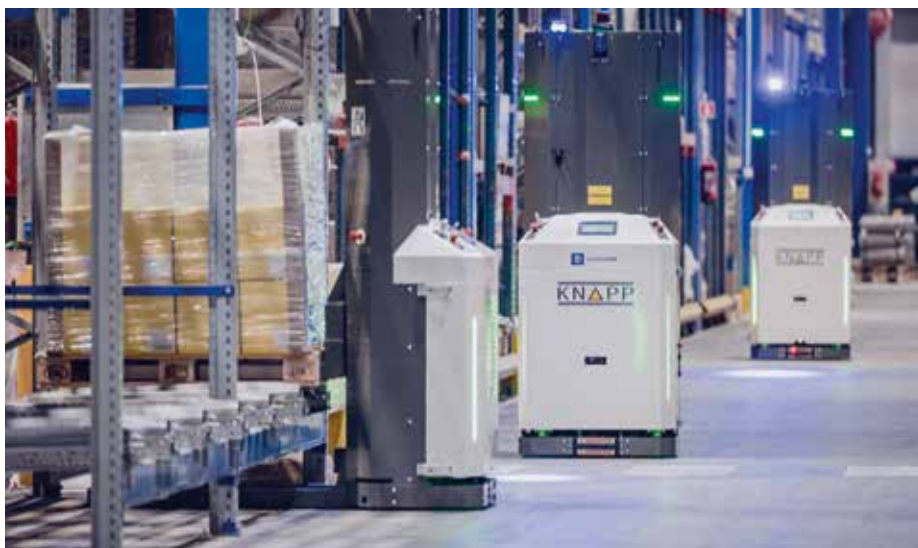
Die Transportaufträge der AMR werden über das „KiSoft Fleet Control System“ (KiSoft FCS) koordiniert.
