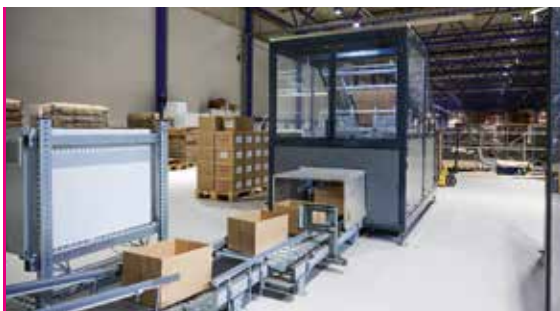
Das integrierte automatisierte Kartonhandling passt die Höhe jeder Box exakt an den Inhalt an. So spart Brødrene Dahl Verpackungsmaterial und reduziert den CO 2 -Fußabdruck.
