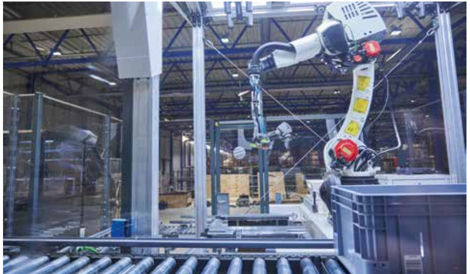
Der „Pick-it-Easy Robot“ führt komplexe Greifvorgänge autonom aus und erhöht die Prozesssicherheit im Lager.
