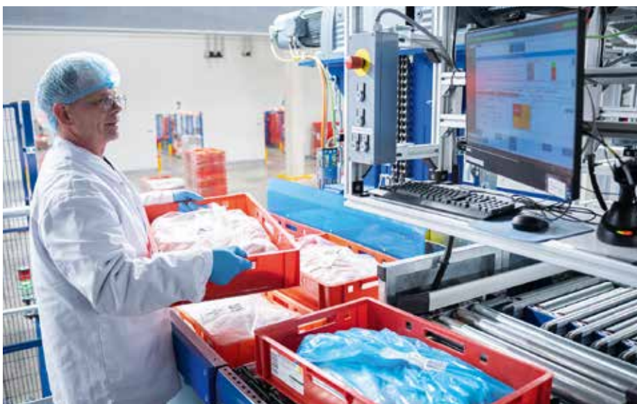
Das Lagerverwaltungssystem leitet den Kommissionierer Schritt für Schritt an. Dabei werden die einzelnen Arbeitsschritte visuell dargestellt.
