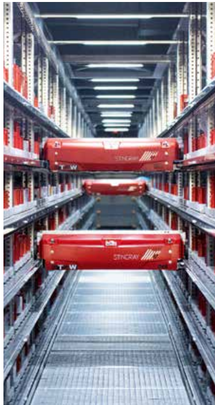
Der Sequenzierungsspeicher besteht im Kern aus einem Shuttle-Lager mit 104 Fahrzeugen, das eine Anlagenleistung von 3.000 Behältern pro Stunde ermöglicht.
