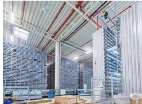
Ein Shuttle-System dient als Auftragszusammenführungspuffer.
