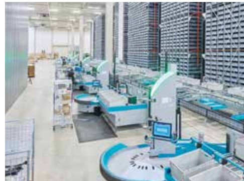
An den Kommissionierplätzen des Exotec-Systems können bis zu vier Auftragsbehälter kommissioniert werden.
