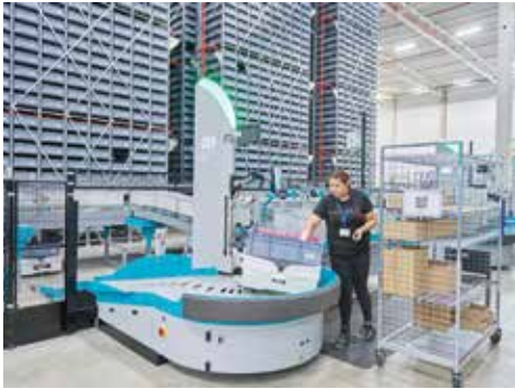
30 Roboter bringen die Ware aus dem Regal zum Kommissionierer.
