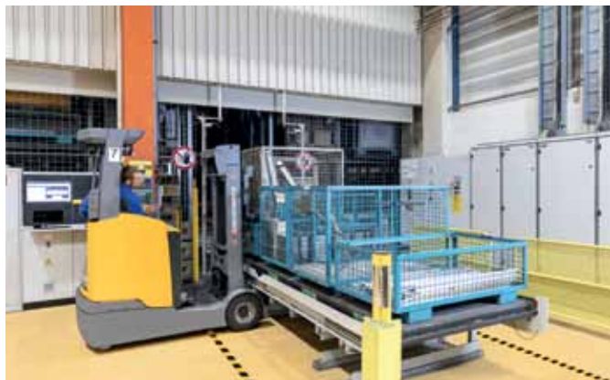
Jede Kassette hat eine Kapazität von drei Tonnen und nimmt Material mit einer Länge von maximal drei Metern auf.
