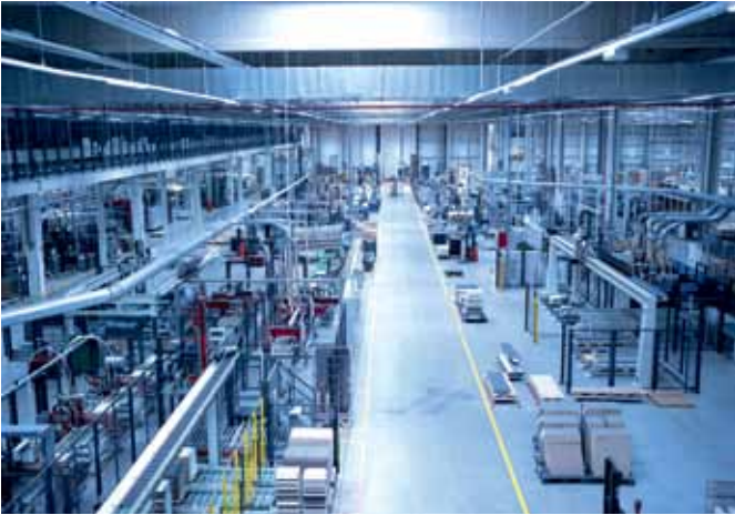
Alle Bauteile laufen vollautomatisch gesteuert, auftragsbezogen und Just-in-sequence durch die Produktion.
