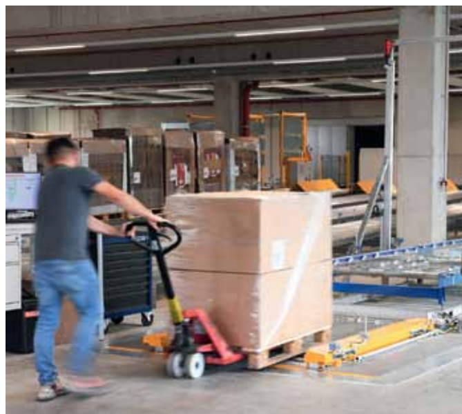
Aufgabe einer Palette mit Prüfung, Erfassung und Einlagern ins System
