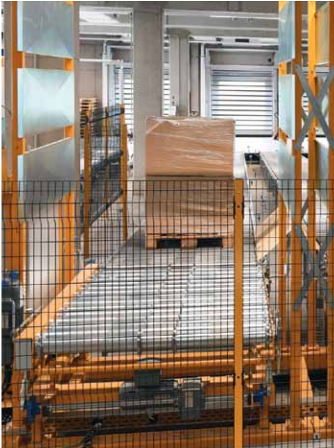
Doppel-Verschiebewagen zur Paletten-Verteilung auf die Versandbahnen
