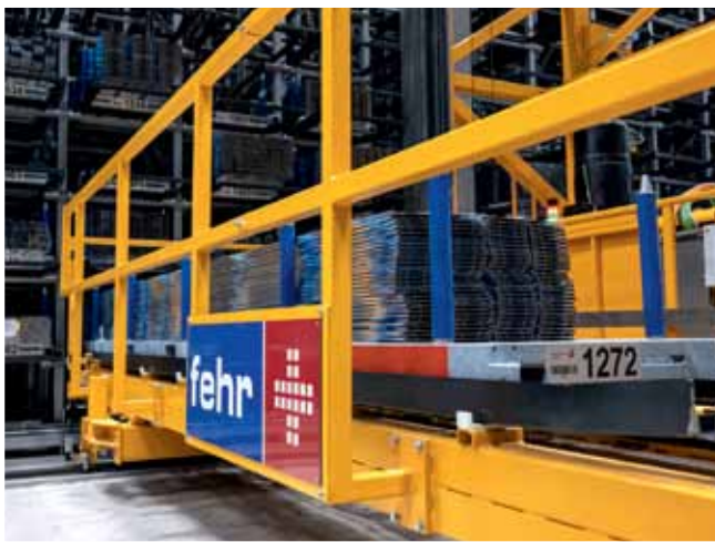
Der Hubwagen des Regalbediengeräts mit einem Lagerkorb voller Fensterprofile
