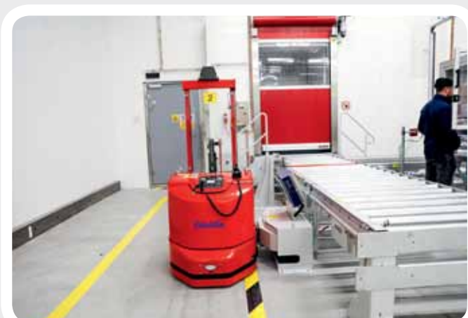
Drei FTS vom Typ „Eagle-Ant 1“ von Stöcklin übernehmen – je nach Prozessschritt – den vollautomatisierten Transport von Paletten und Kartons zwischen der Fördertechnik, den 22 Pufferplätzen, den automatischen und manuellen De-/Palettierstationen, dem über zwei Stockwerke reichenden Schockfroster und der Radio-Frequency-Akklimatisierungsanlage.
