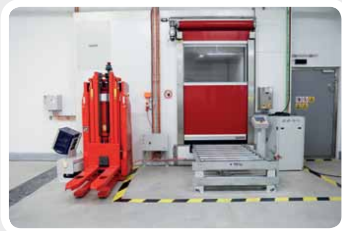
Für die zweistöckige Palettenlagerung speziell ausgelegte selbst-fahrende Transportfahrzeuge vom Typ „Eagle-Ant 2“ von Stöcklin.
