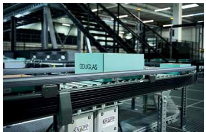
B2C-Aufträge werden in neun verschiedenen Kartongrößen kommissioniert. Diese werden während des Verschließens außerdem in ihrer Höhe reduziert, um möglichst wenig Luft in den Versandstücken zu transportieren.
