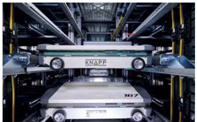
Die 2D-Shuttle-Lösung gilt als die weltweit größte im Kosmetikbereich und bietet ein Höchstmaß an Flexibilität und Lagerdichte.
