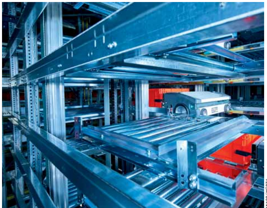
Einer der Hauptgründe für die Entscheidung für Knapp ist das sauerstoffreduzierte „Evo Shuttle“. Durch diese besondere Anpassung kann Würth beinahe sein gesamtes Artikelspektrum im Shuttlesystem lagern, auch leicht entzündliche Artikel.
