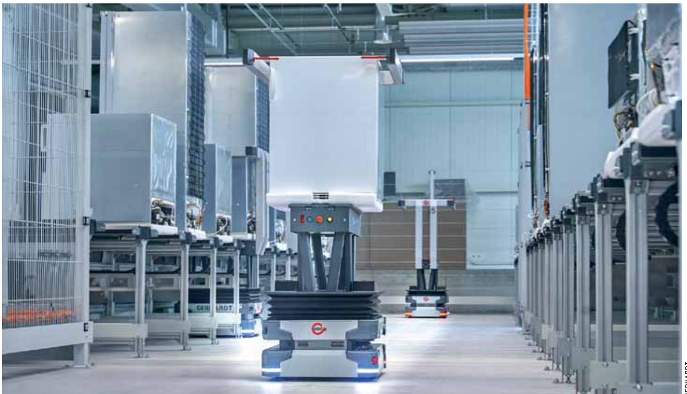
Fünf „Gebhardt Karis“ bedienen die insgesamt 90 Prüfplätze bei V-Zug und realisieren einen Durchsatz von 410 Prüfungen in der Stunde.
