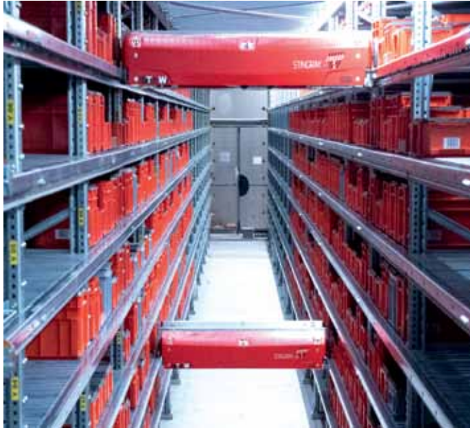
Das neue Shuttle-Lager verfügt über 43.000 Stellplätze in zwei Gassen mit 42 Regalebenen.
