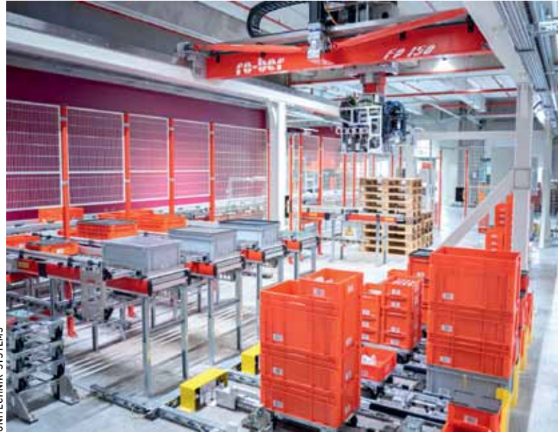
Der Portalroboter kann bis zu sechs verschiedene Behältertypen (mit und ohne Deckel) sowie Europaletten und Bodenroller greifen.
