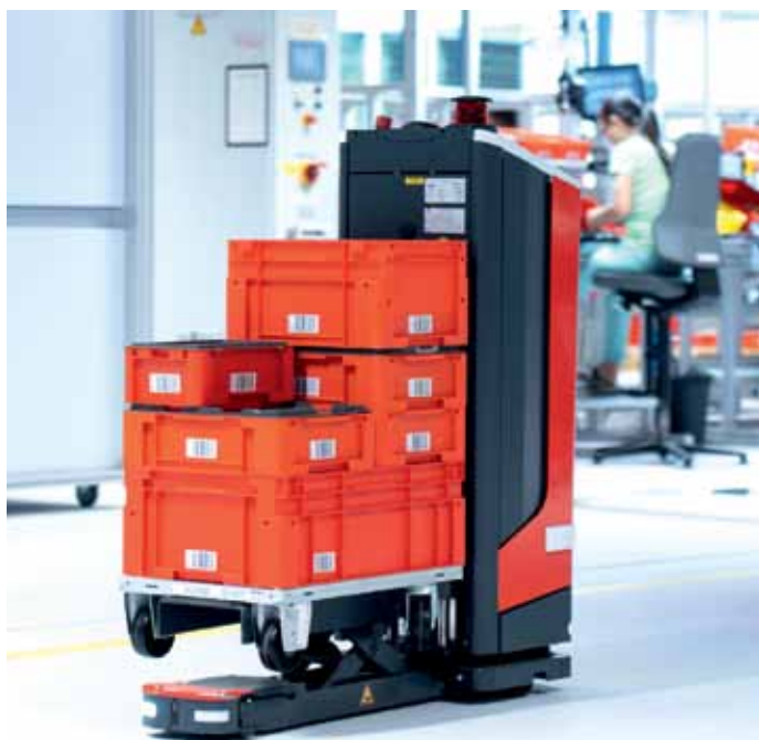
AMR transportieren die Bodenroller vom Supermarkt an die jeweilige Produktionslinie.
