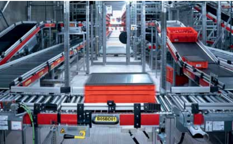
Die Behälterfördertechnik verbindet das Lager mit der Kommissionierung und den Roboterübergabepunkten.
