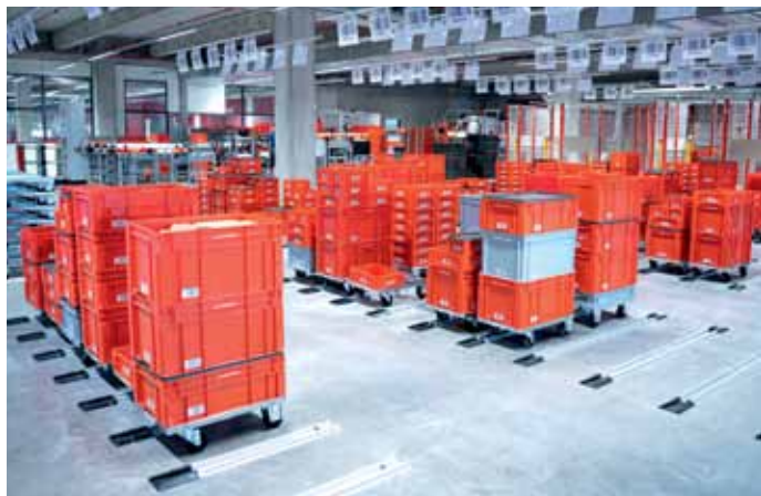
Ein Pufferbereich, auch Supermarkt genannt, entkoppelt die Produktion vom Lagerbereich.
