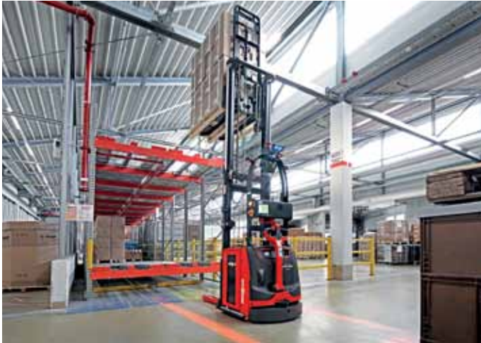
Beim Einlagern der Ware auf bis zu vier Metern Höhe erkennt die hochentwickelte Sensorik des „Linde L-Matic HD“, welche Bahnen des Durchlaufregals gerade belegt sind. Anschließend platzieren die automatisierten Hochhubwagen die Paletten auf den freien Plätzen.
