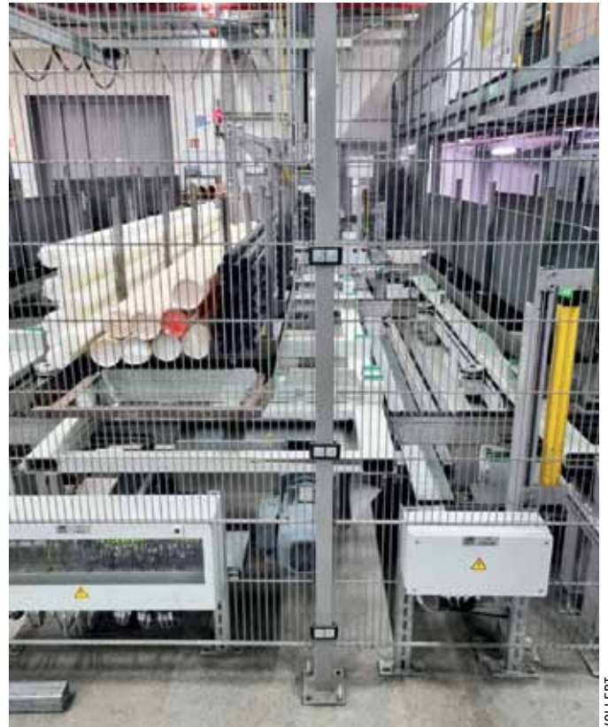
Querkettenförderer vorher: Flaschenhals in der Produktion. Zu kurze Förderstrecken eines bestehenden Querkettenförderers führten bei Ensinger immer wieder zu Verzögerungen und Wartezeiten bei der Ein- und Auslagerung eines Hochregallagers.
