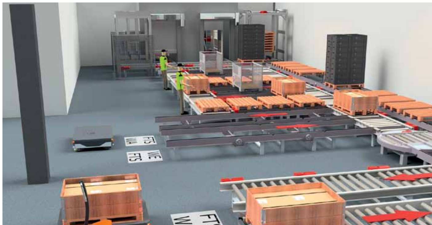
Die nahtlose Anbindung der Fahrerlosen Transportsysteme im Warenein- und -ausgang stellt einen unterbrechungsfreien Materialfluss sicher.
