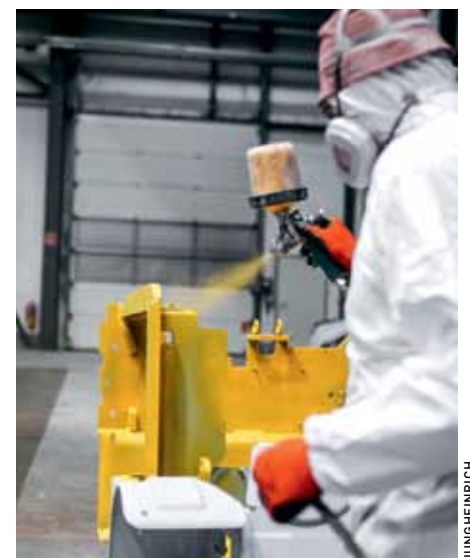
Fahrzeugrahmen und Mast werden gespachtelt, geschliffen und lackiert.
