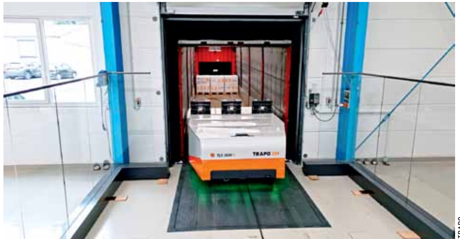
Personenfreie Ladezone dank TLS 3600: Durch den Verzicht auf Gabelstapler im Lager und Ladebereich verringert sich die Unfallgefahr.
