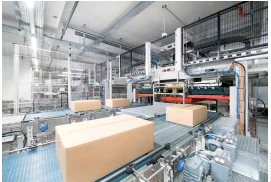
Modulare Lösung für das Mixed Case Palletizing
