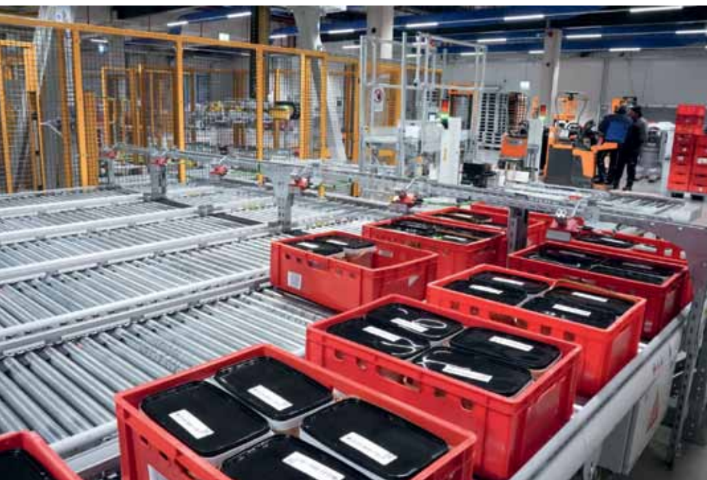
Die sogenannte „Warenausgangsharfe“ besteht aus sechs parallelen Förderstrecken und stellt die Aufträge bereit.
