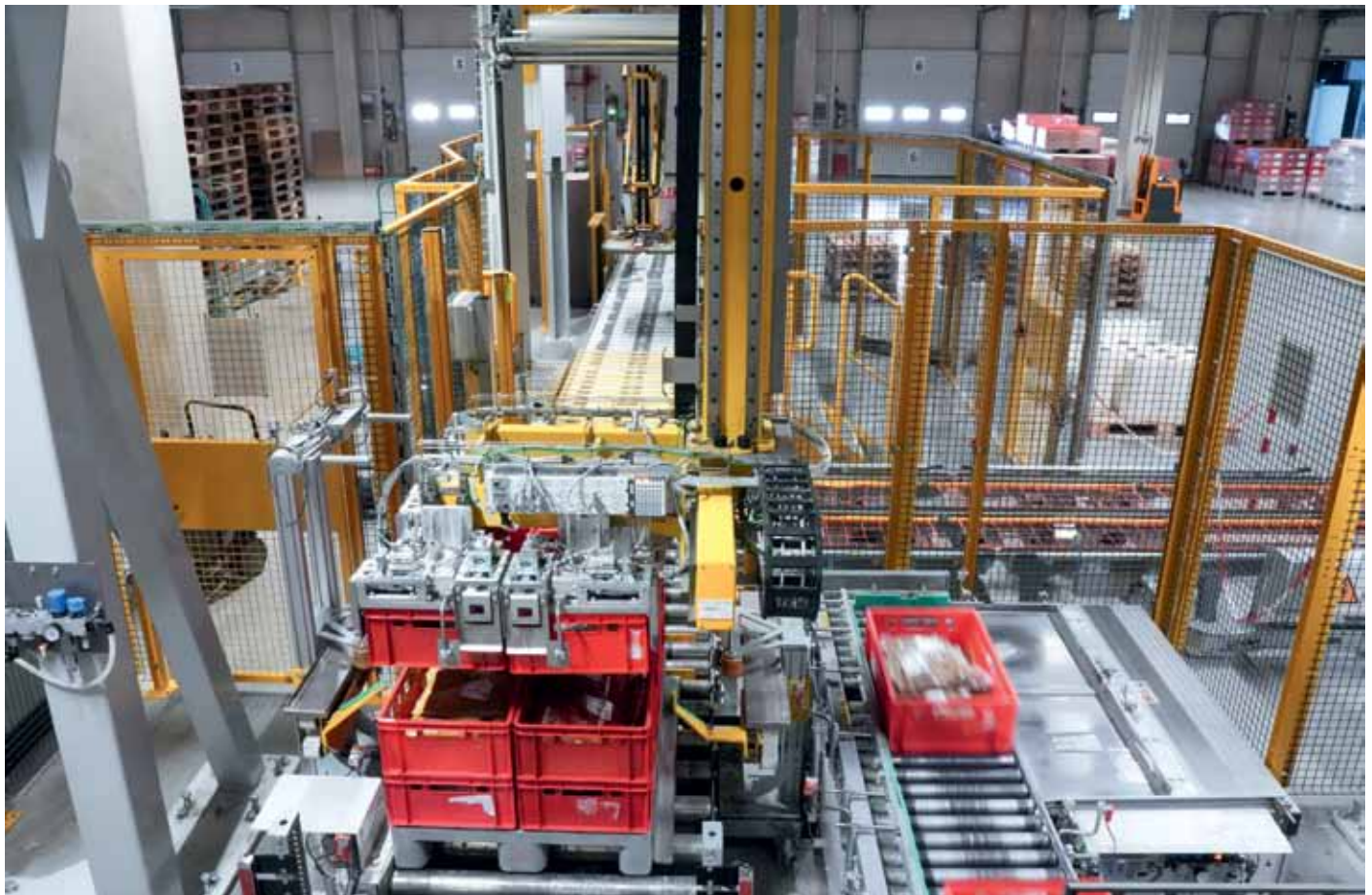
Am Warenausgang stapelt ein Portalroboter bis zu 20 Behälter automatisch auf die zugewiesene Palette oder Gitterwagen.
