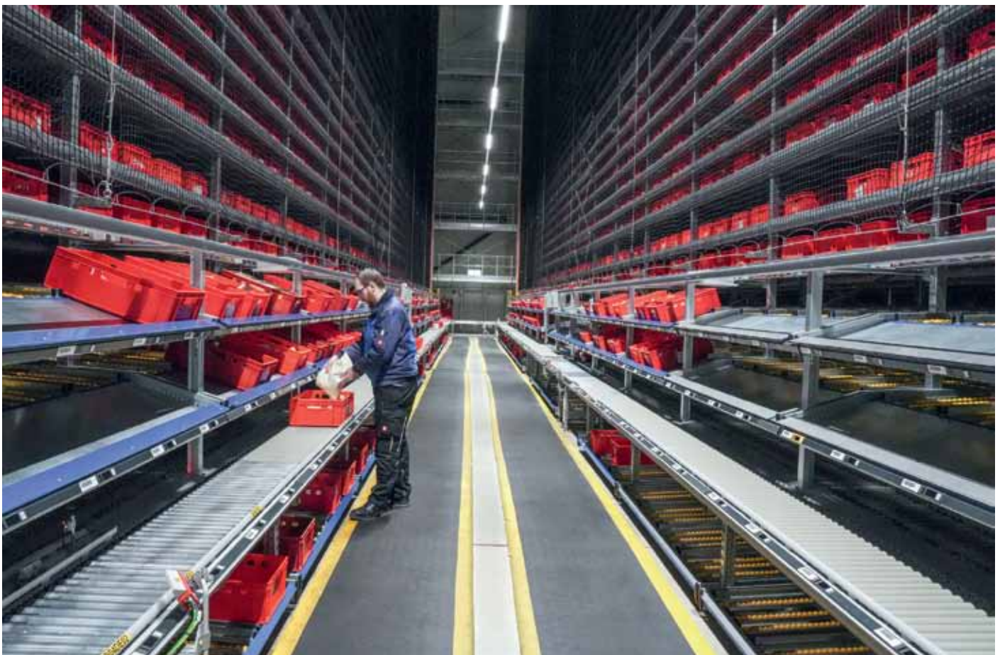
Das Shuttlelager versorgt 488 Durchlaufkanäle, die mehrere Kommissionier-Bahnhöfe bilden.
