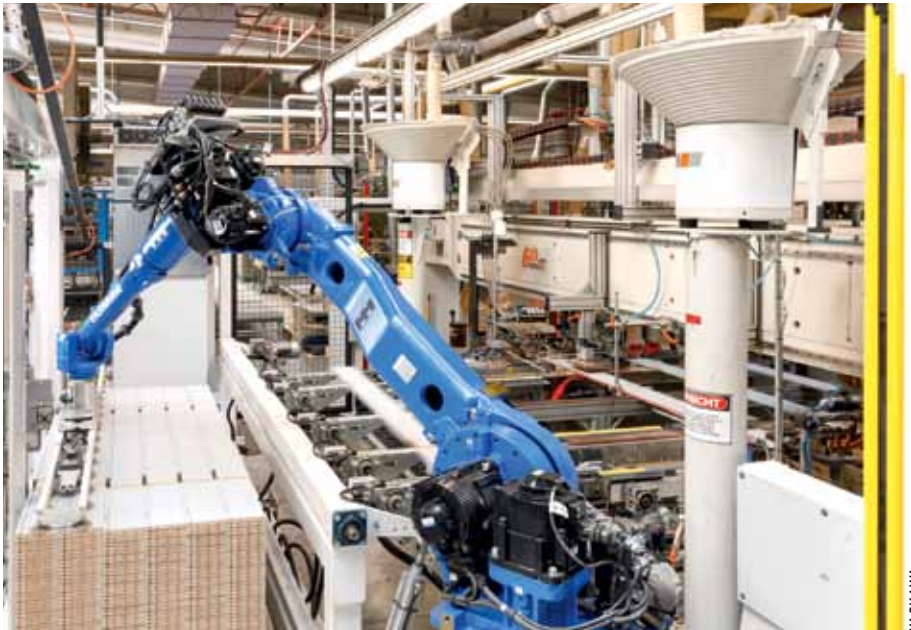
Der Motoman GP35L zeichnet sich durch einen extra langen Arm aus und ist damit auch für große Bauteile geeignet.
