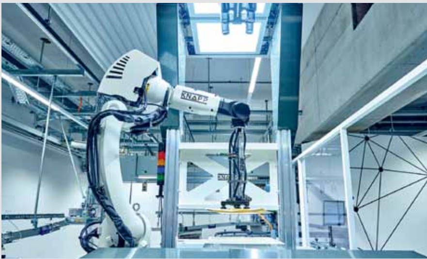
Industrietauglicher Kommissionierroboter: Der „Pick-it-Easy Robot“
