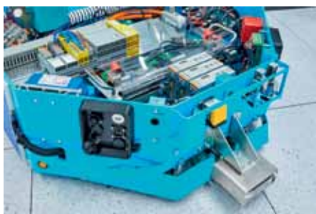
Die „PLCnext“-Steuerungsplattform umfasst eine linksanreihbare Safety-SPS.
