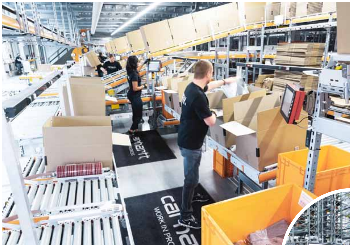
Die zehn Kommissionierplätze werden kontinuierlich und stets in der richtigen Abfolge mit den zwischengepufferten Kartons aus den Sequence Tovern versorgt.
