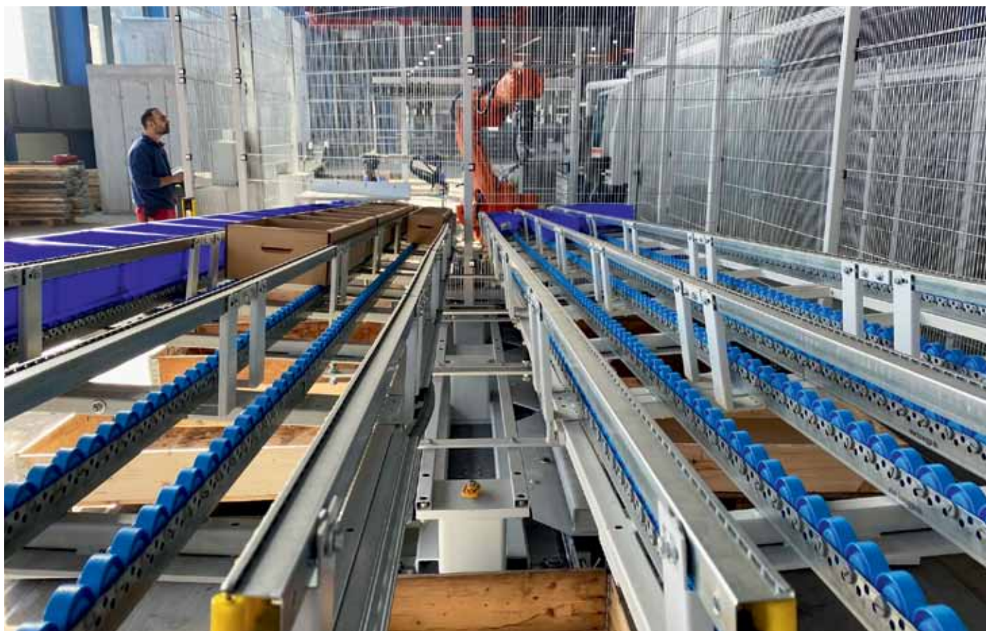
Über abschüssige Rollenbahnen werden Karton- und Kunststoffboxen in unterschiedlichen Größen an der Säge bereitgestellt.
