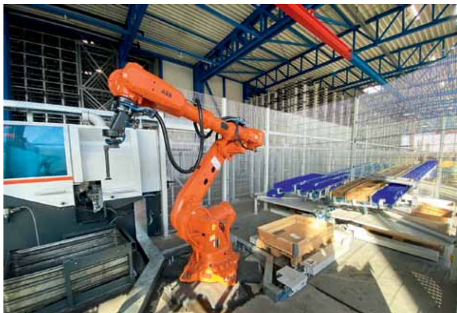
Ein Roboter platziert mithilfe eines Saugers die benötigten Boxen auf einer bereitstehenden Palette und befüllt diese mit den Sägeabschnitten.
