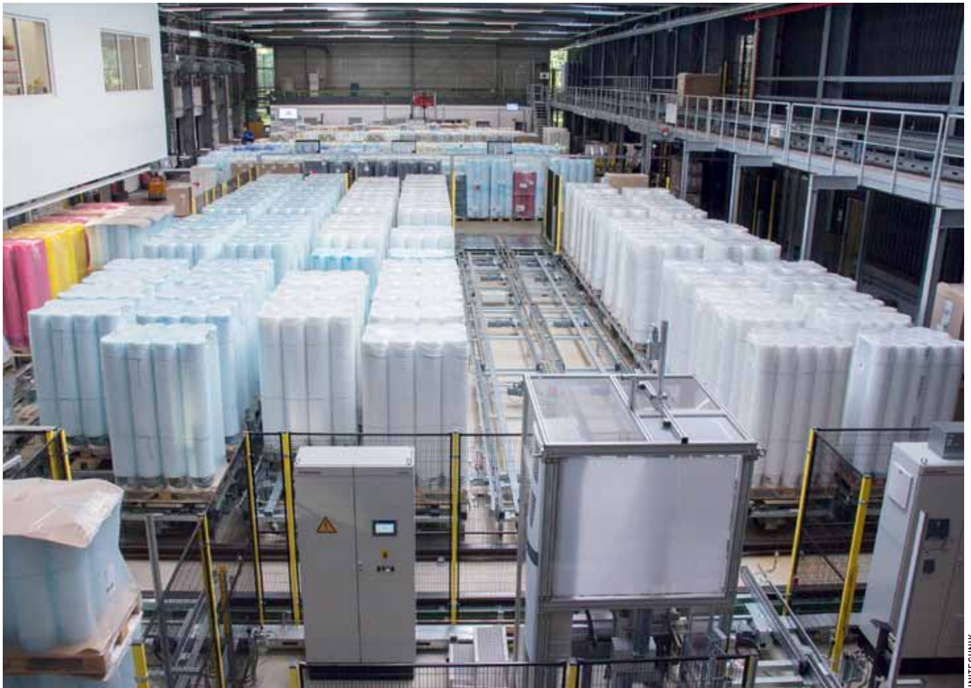
Ein Querverschiebewagen verteilt die Paletten dann auf insgesamt 14 Bereitstellungsbahnen.
