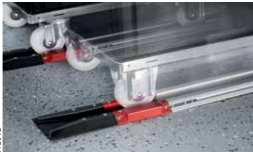
In den „Bahnhöfen“ oder „Materialsupermärkten“ erfassen Sensoren die Position von Dollies und Routenzug-Anhängern.
