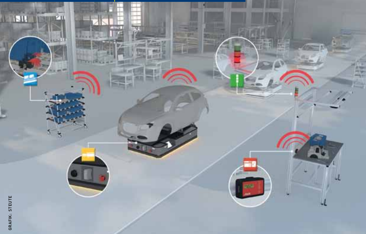
Blick von oben: Lasersensoren erkennen und melden das Vorhandensein von Paletten oder Behältern sowie Füllstände zum Beispiel in GLT.
