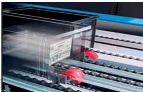
Die Position der Behälter im Regal wird über Sensoren erfasst, das Signal per Funk übertragen
