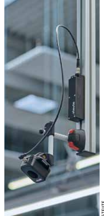
Blick von oben: Lasersensoren erkennen und melden das Vorhandensein von Paletten oder Behältern sowie Füllstände zum Beispiel in GLT.
