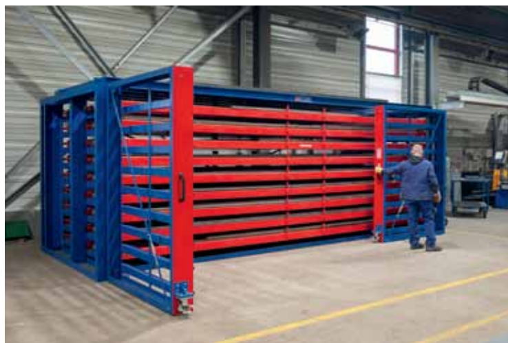
Der schwenkbare Vorbau wird einfach per Hand bewegt.
