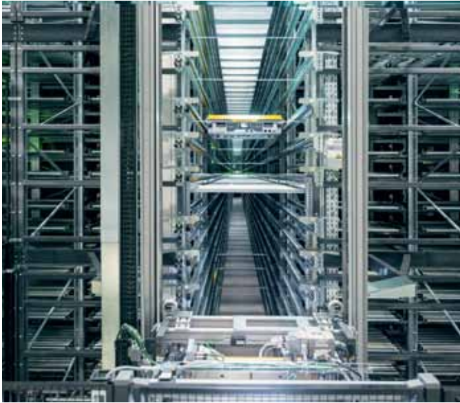
Das dreigassige Lager, realisiert als Roaming+-Konzept mit insgesamt 15 „StoreBiter“-OLS, erreicht 630 Doppelspiele je Stunde.
