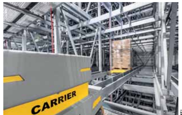
Zwölf Carrier mit Shuttles bedienen zwölf Ebenen.
