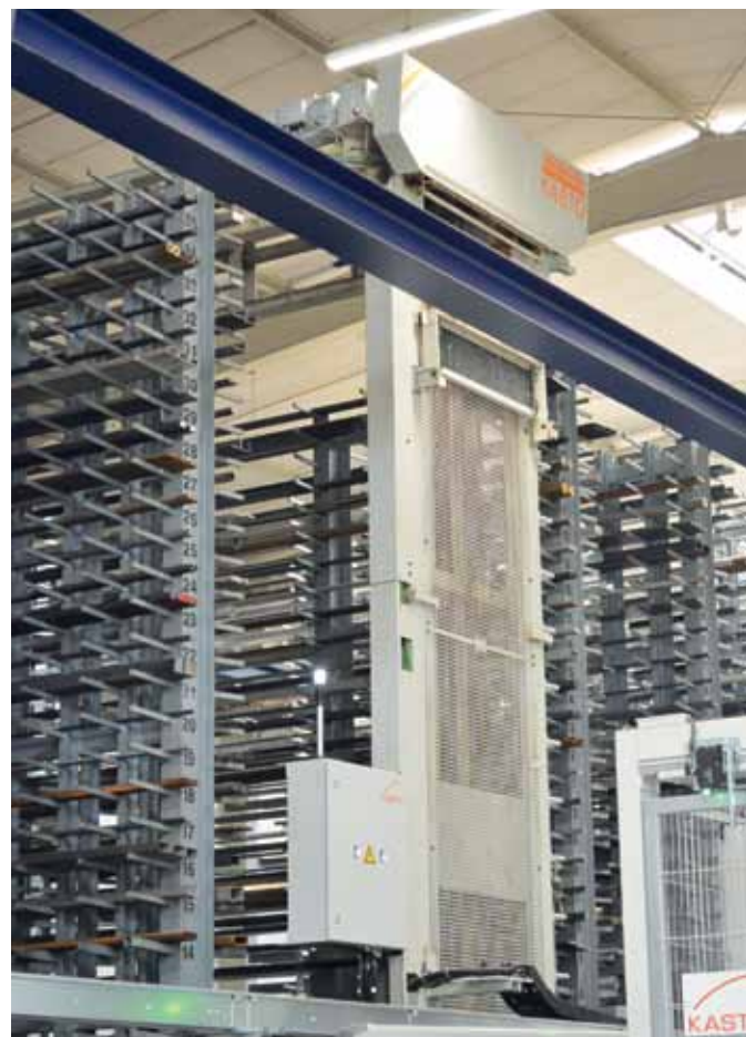
In dem sechs Meter hohen System lagern in 1.037 Fächern Rund- und Flachmaterialien, Rohre, Hohlprofile und Winkel in zahlreichen Querschnitten und Werkstoffen.
