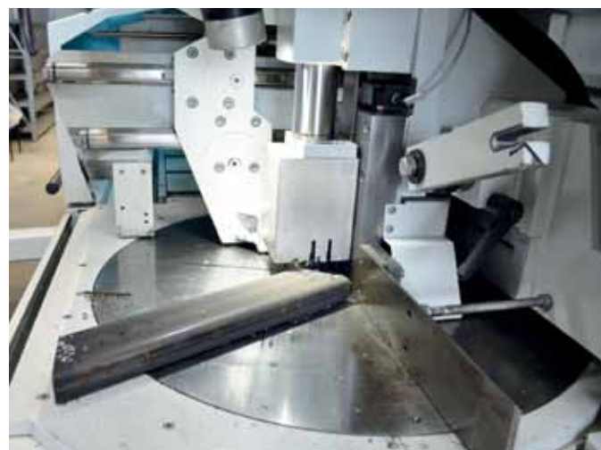
Von Hand oder per Hallenkran entnimmt der Bediener die zu sägenden Stangen, Rohre oder Profile aus der Übergabestation.
