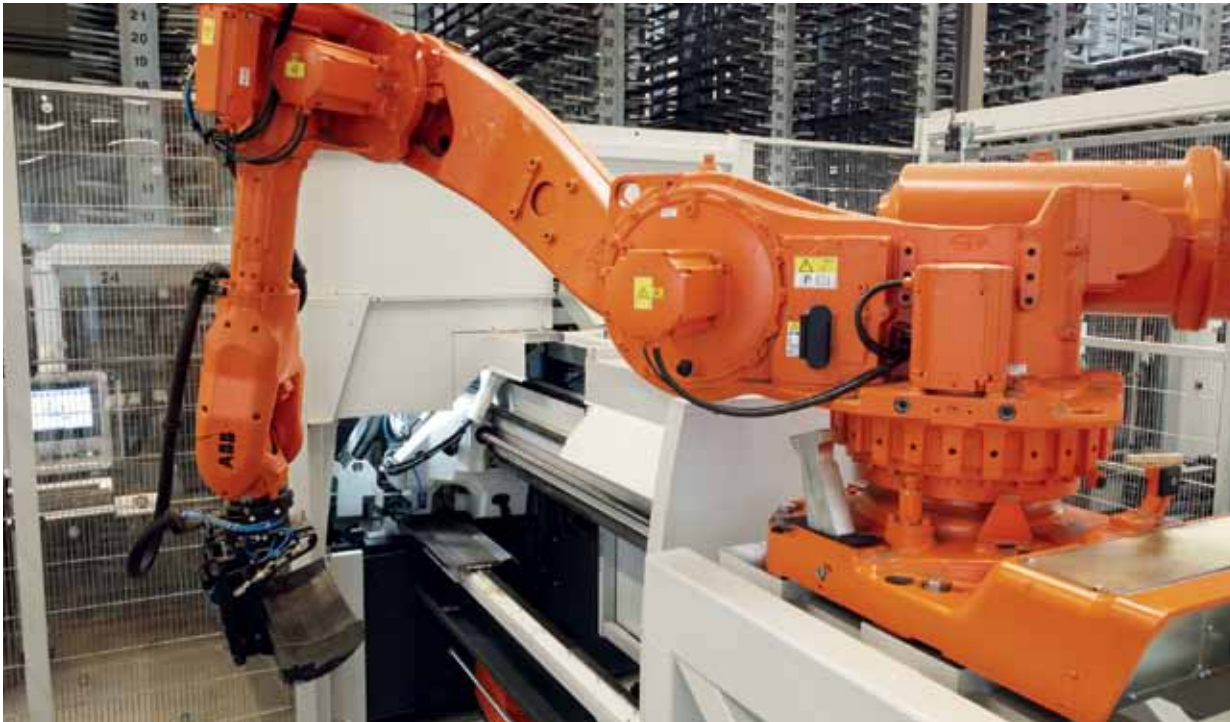
Mit einem Vakuumbreifer holt der Roboter zudem Etiketten von einem Drucker ab und platziert diese in den jeweiligen Behältern.
