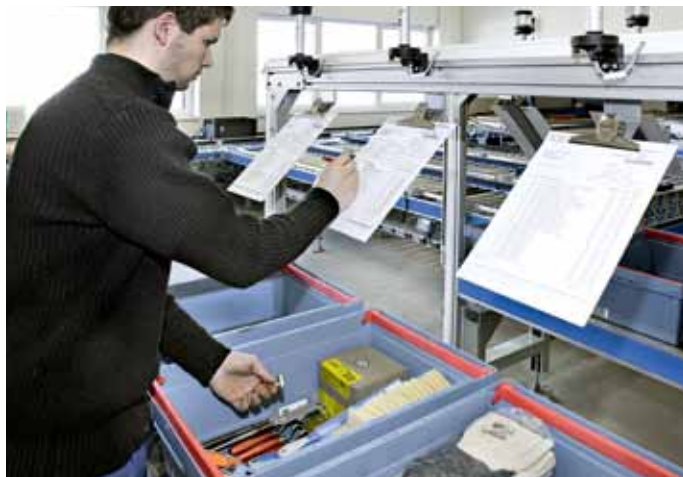
Die Kommissionierung in Kunststoffbehälter erfolgte über die Realisierung eines Pick-to-Light-Kommissioniersystems und entsprechender Lagerverwaltungssoftware.
