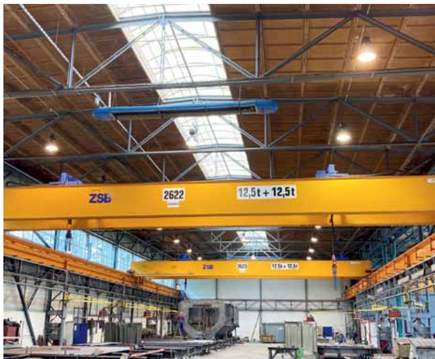
Die beiden Handling-Krane mit 22,5 Metern Brückenlänge und 2 mal 12,5 Tonnen Tragfähigkeit sind als Standardkrane ausgelegt.
