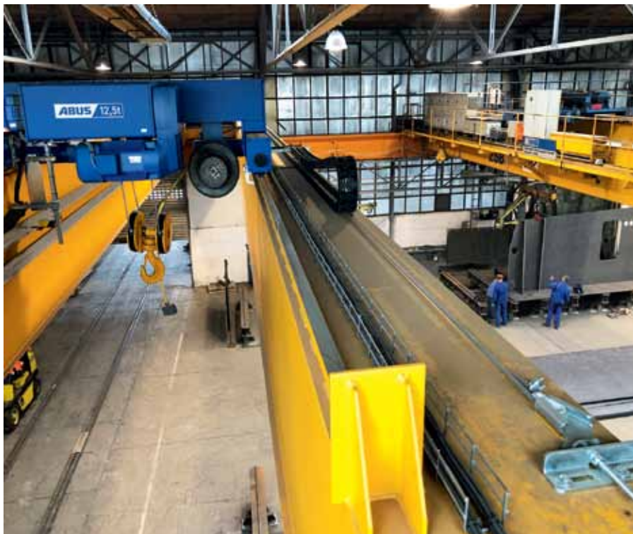
Die „Autoglide 5“ kommt ohne Führungsrinne aus. Das spart Platz, Kosten und Montagezeit.
