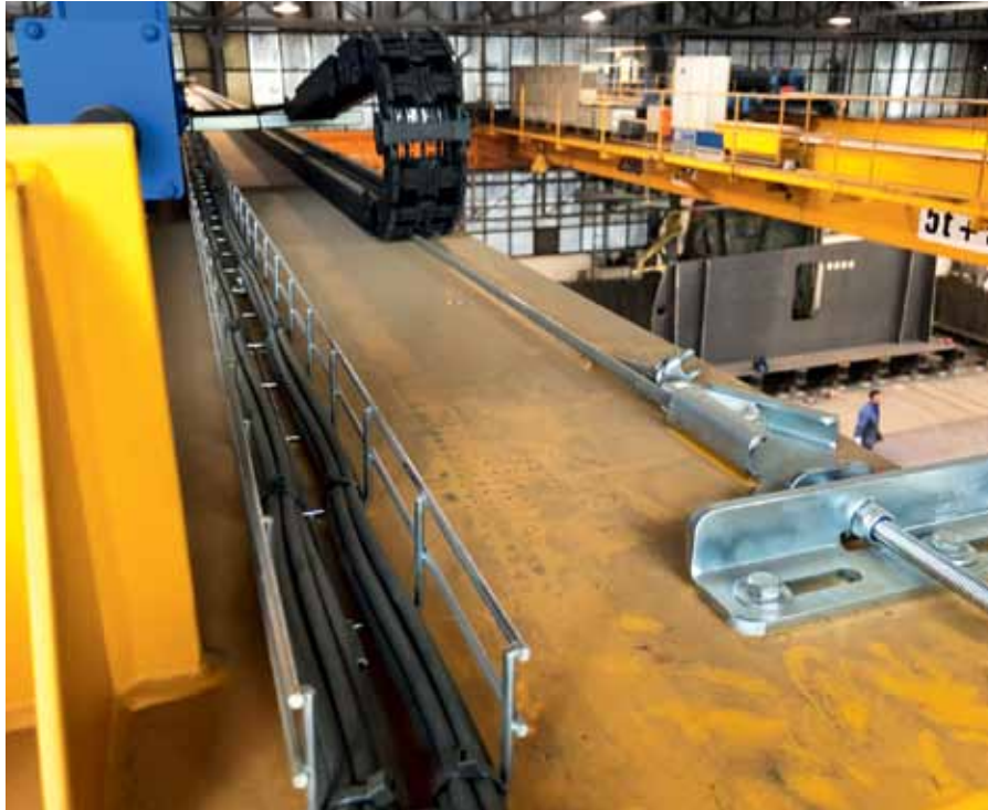
Das Seil greift in die Führungselemente der Kette ein. Mehr braucht man nicht, um die Energiekette sicher zu führen.
