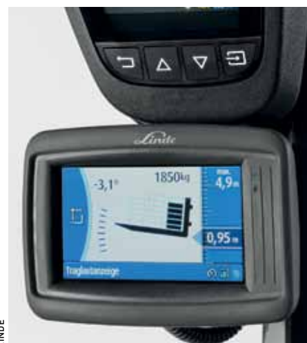
Der „Safety Pilot“ hilft dem Staplerfahrer beim sicheren Umgang mit seinem Arbeitsgerät. Wesentlicher Bestandteil des Assistenzsystems ist das elektronische Traglastdiagramm.
