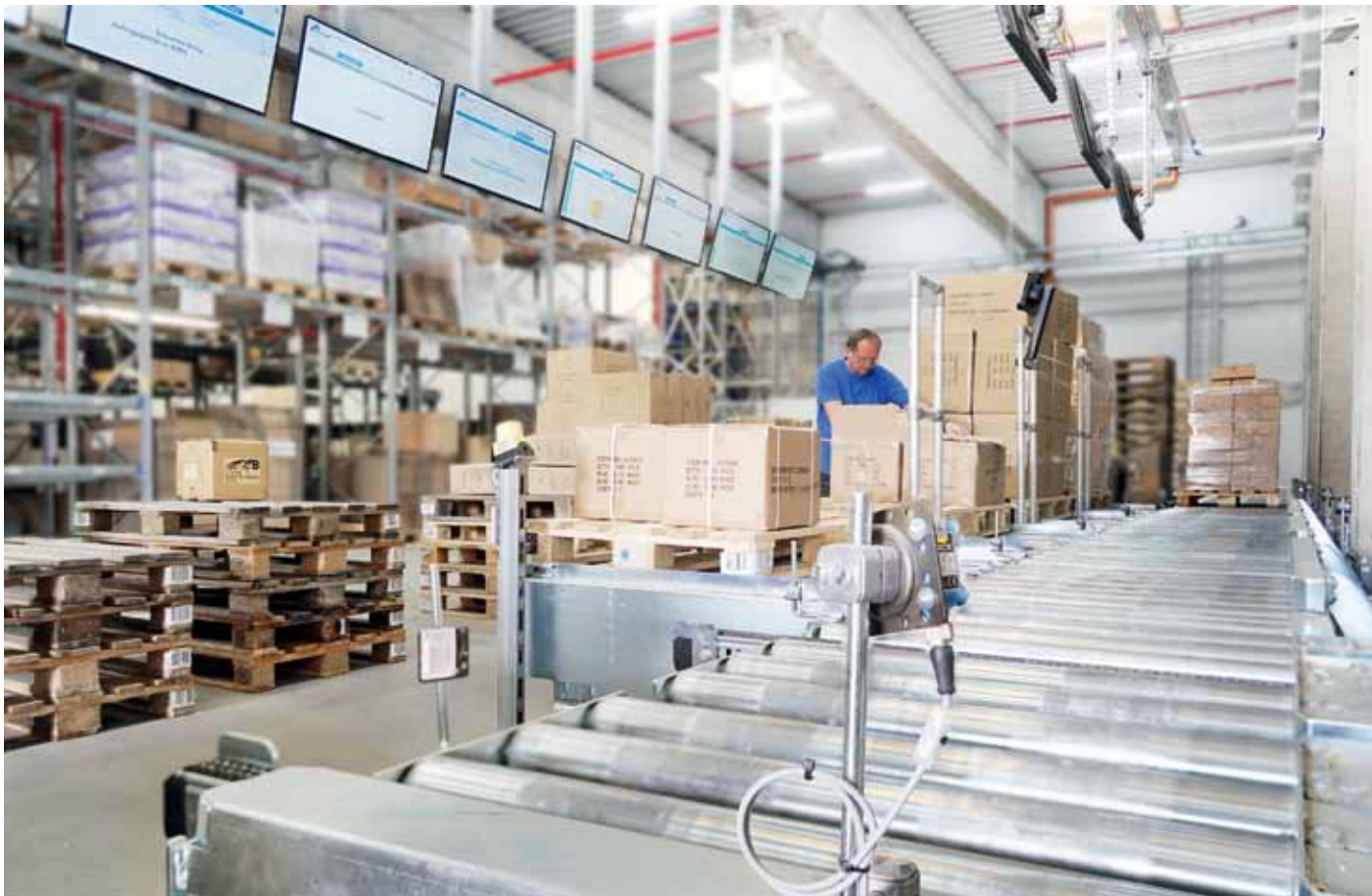
Fördertechnische Anbindung von, mit Displays ausgestatteten, Multi-Order-Picking-Plätzen für Paletten mit 4 Entnahme- und 8 Zielplätzen
