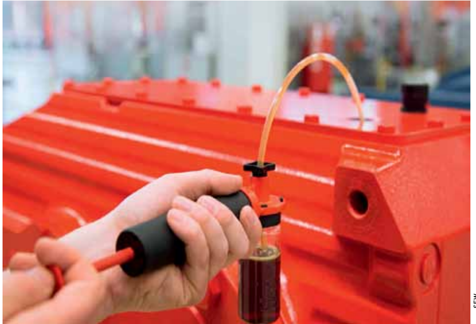
Klarheit über den aktuellen Zustand des Getriebeöls liefern regelmäßige Ölanalysen
