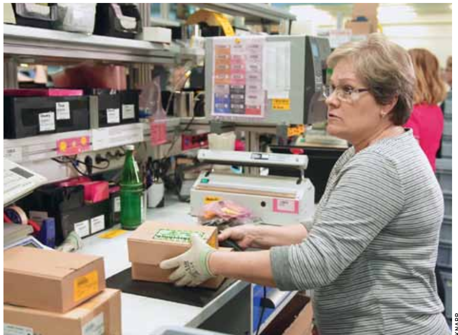
Bei Schukat electronic sind aktuell sechs Ware-zur-Person-Arbeitsplätze im Einsatz. Hier können 1.200 Auftragszeilen pro Stunde bearbeitet werden. Die Anzahl der Arbeitsplätze kann verdoppelt werden.
