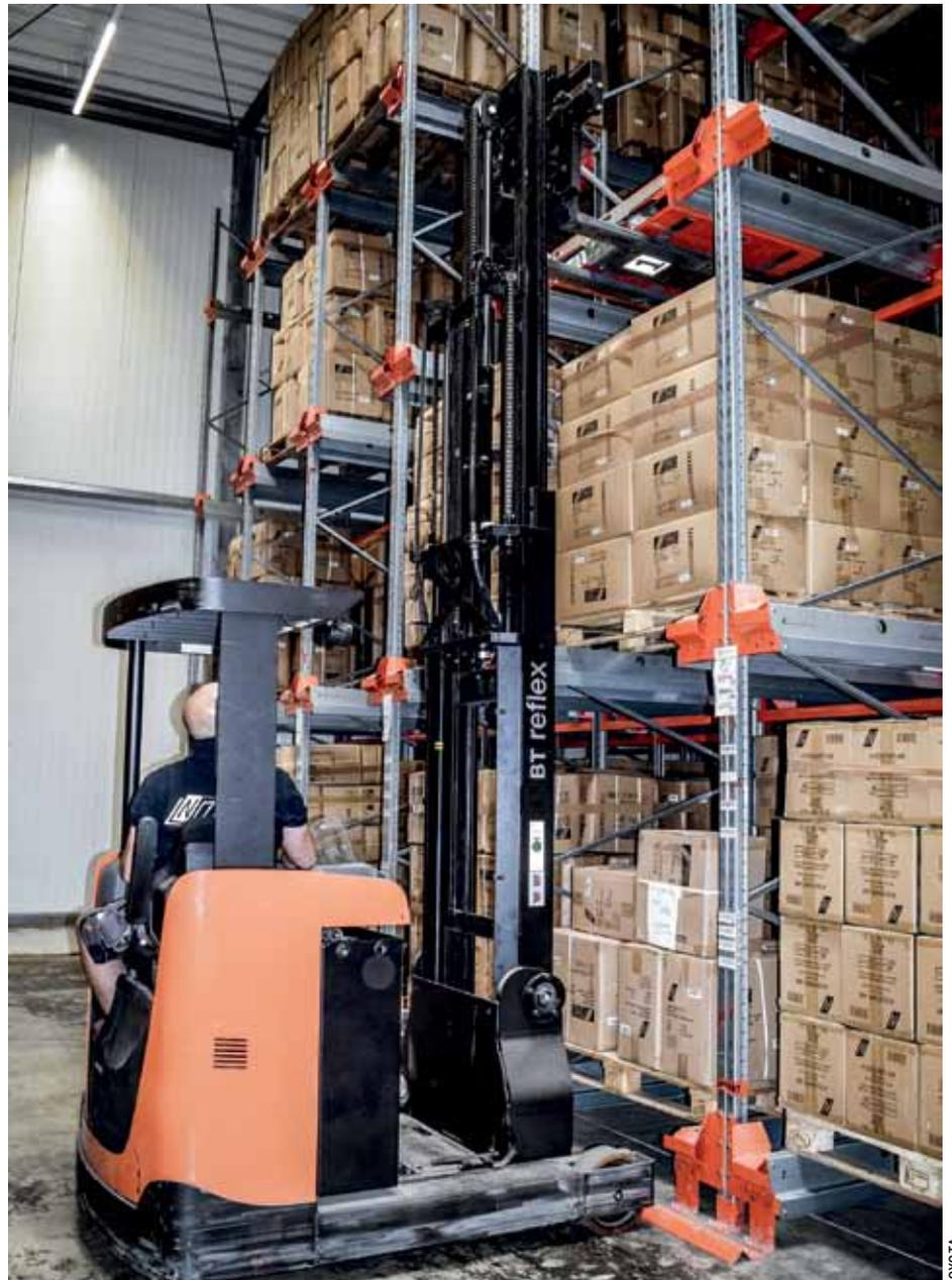
Über die bedienerfreundliche Fernbedienung steuert der Staplerfahrer alle wichtigen „BT-Radioshuttle“-Vorgänge und kann während der Einlagerung bereits die nächste Palette aufnehmen.
