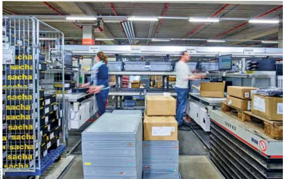
Nach der Vereinnahmung werden die Artikel an 16 höhenverstellbaren Arbeitsplätzen in Lagerbehälter umgepackt. Neue Artikel mit unbekannten Stammdaten werden von einem der drei Messgeräte vermessen.
