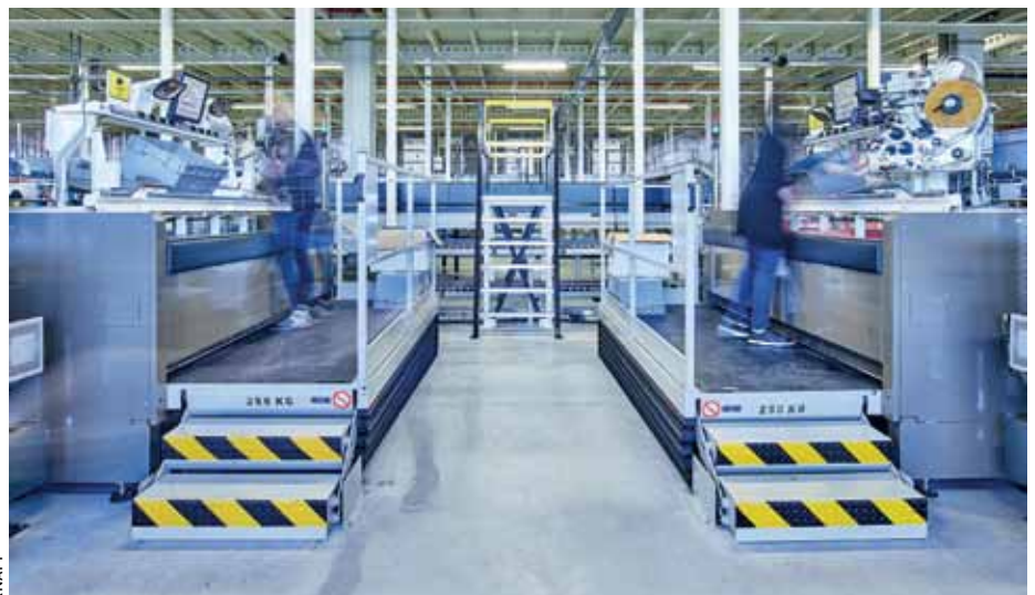
Die Kommissionierung nach dem Ware-zur-Person-Prinzip erfolgt an den 28 „Pick-it-Easy-Health“-Arbeitsplätzen, die mit Waren aus dem OSR Shuttle versorgt werden.
