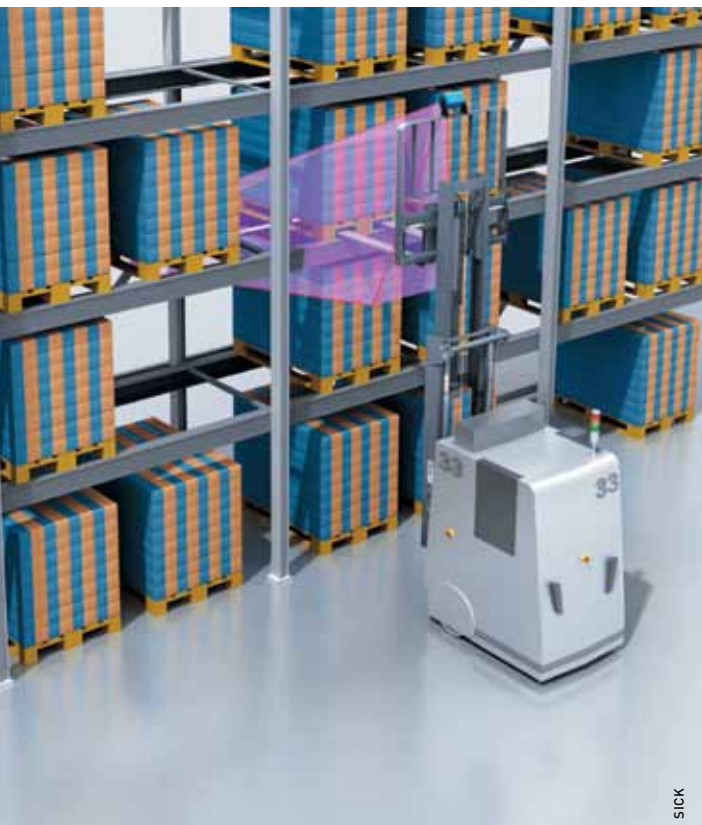
Die ersten FTS-Aufgabenstellungen sind die Palettendetektion und die Erfassung der Ecken von Rollwagen.
