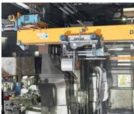
*Deckenkran mit Seilzug kurz nach der Installation*
