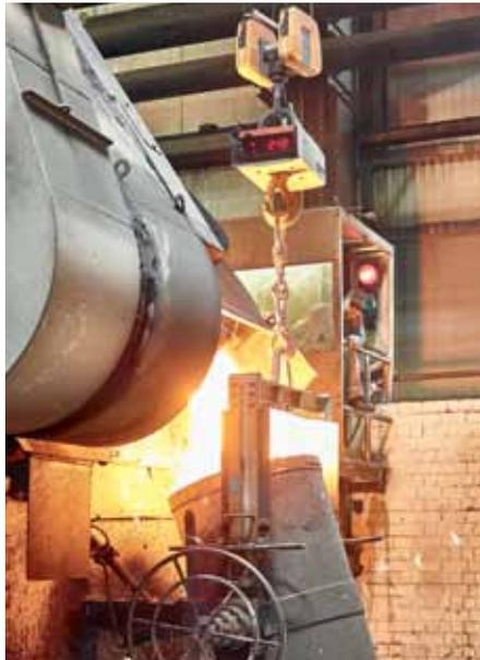
*Das Gewicht des aus den Schmelzöfen fließenden Materials wird angezeigt.*
