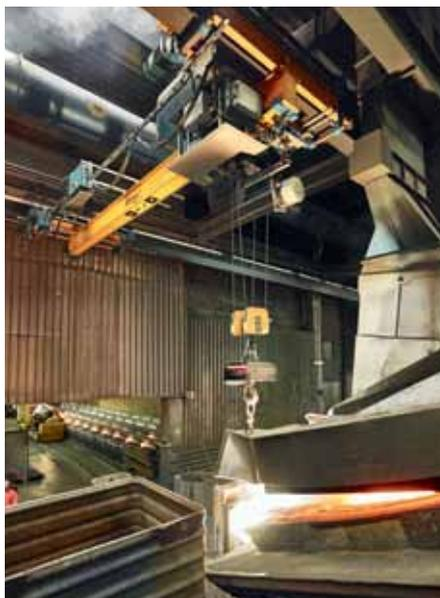
*Typisch für Gießereikrane: Das Hitzeschutzblech schützt den Seilzug vor zu hohen Temperaturen. Alle vier Fahrwerke sind angetrieben, zwei reichen für den Kranbetrieb.*
