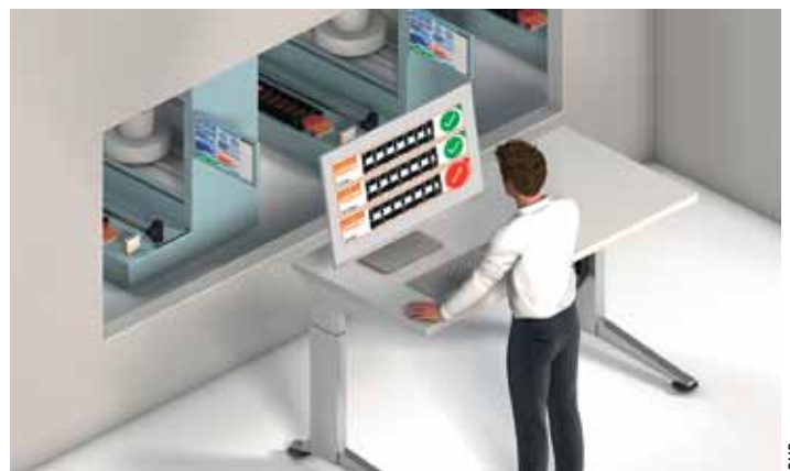
Muss ein Servicetechniker an einer Produktionsanlage eine Vielzahl an Energieketten oder Leitungen überwachen, bietet sich das System „Isense-offline“ an. Benötigt wird dafür ein zusätzlicher Industrie-PC, an dem alle Meldungen angezeigt werden.
