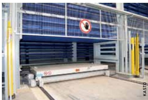
An der Frontseite des Lagers im Inneren der Halle befinden sich sieben weitere Stationen mit Querwagen zur Aus- und Rücklagerung des Materials.
