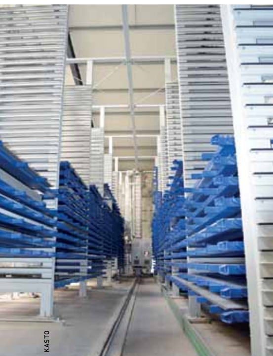
An der Frontseite des Lagers im Inneren der Halle befinden sich sieben weitere Stationen mit Querwagen zur Aus- und Rücklagerung des Materials.
