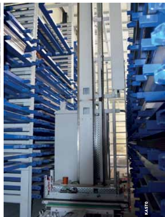
An der Frontseite des Lagers im Inneren der Halle befinden sich sieben weitere Stationen mit Querwagen zur Aus- und Rücklagerung des Materials.
