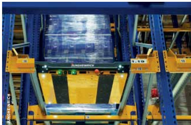
Das UPC fährt selbstständig unter die gelagerten Paletten, ohne mit einem Trägerfahrzeug verbunden zu sein.
