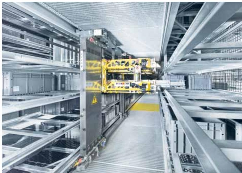
*Im Shuttle-Lager bei der finnischen Warenhauskette Stockmann übernehmen 72 Mehrebenen-Shuttles vom Typ „Navette“ die Ein- und Auslagerung von bis zu vier Behältern gleichzeitig.*
