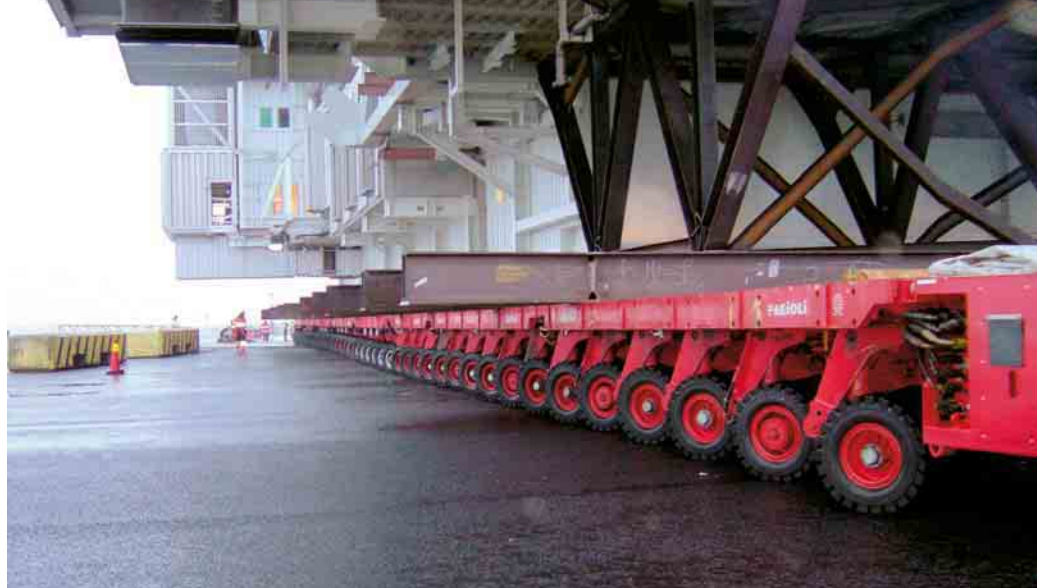
Hydrostatisch angetriebene InterCombi-Einheiten gehören schon lange zum Lieferprogramm. Mit dem SPMT 3000-SPIC kommt nun die elektronisch gelenkte Variante auf den Markt. (Bild: Scheuerle)
