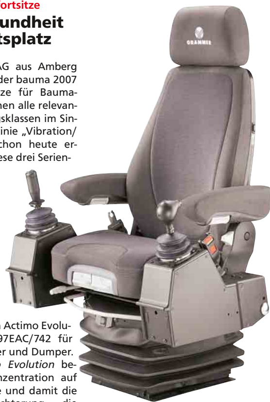
Komfortsitz Actimo Evolution mit Steuerhebelträger
