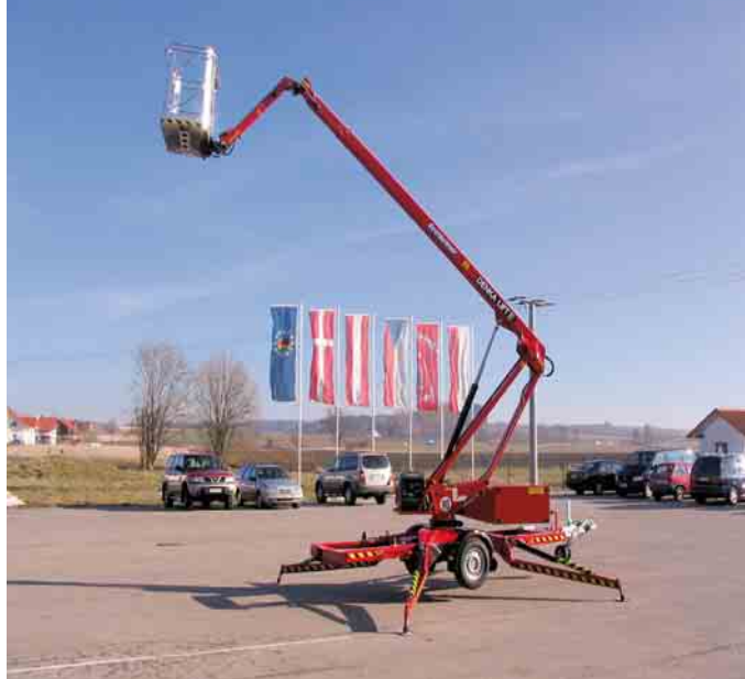
Neuheit: Denka-Lift DLX15 mit beweglichem Korbarm (Bild: Rothlehner)
