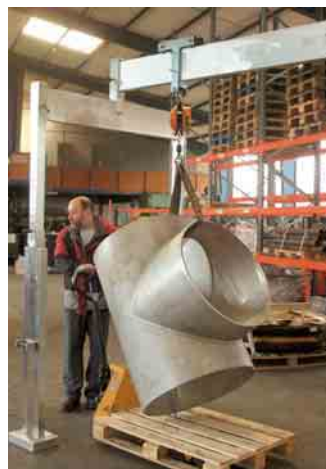
Die Last kann durch das Portal hindurch geführt werden
