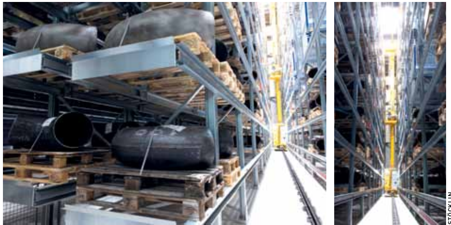
Seit dem Go-Live im August 2020 wird das Intralogistik-System regulär an sechs Tagen zu je 16 Stunden betrieben. Das Automotive-Lager ist für die Aufnahme von 2.028 Paletten ausgelegt, während das Zubehör-Lager eine Kapazität von 1.950 Stellplätzen aufweist.
