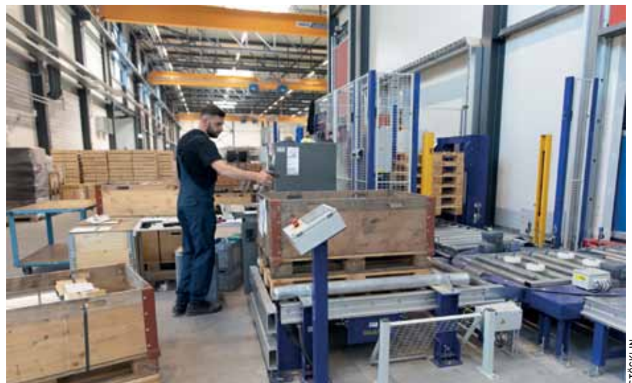
An allen Aufgabe- und Abnahmestellen sowie am Kommissionier-Arbeitsplatz erfolgt die Erfassung der Paletten und Kleinteilegebände per Handheld-Scanner.
