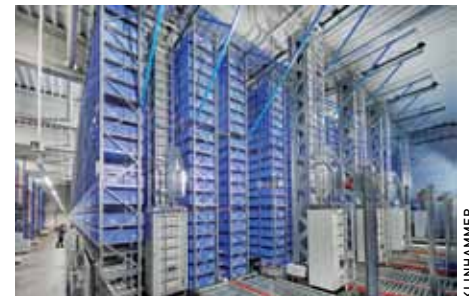
Siebengassiges AKL mit Auftragszusammenführungspuffer und Durchlaufkanälen
