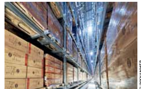
Platzsparende Automatisierung im zweigassigen, fünffachtiefen Kanallager mit 13.200 Paletten-Stellplätzen
