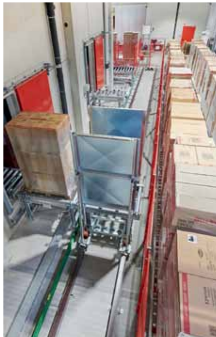
Blick in die Vorzone des automatischen Kanallagers – dies ist fünffachtief ausgelegt und beinhaltet Dach- und Wandverkleidung.
