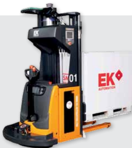
Zur Überbrückung kürzerer oder überdachter Strecken: EK Automation rüstet auch Gabelfahrzeuge der Sparte „Smart Move“ mit Outdoor-Scannern nach.
