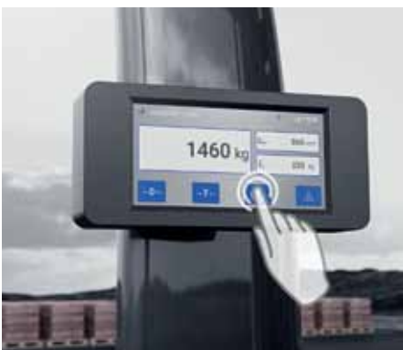
Anwenderfreundlich: Auf dem „Smart Display“ wird das Gewicht und der Lastschwerpunkt angezeigt.
